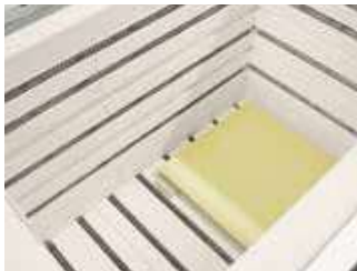
Brennraum mit 5-seitiger Beheizung
